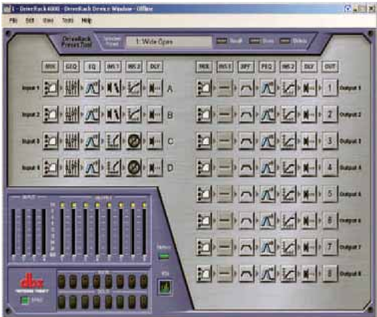
Bearbeitungsblöcke des dbx DriveRack 4800
