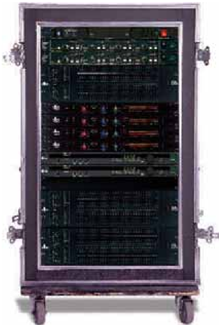
Konventionelles Drive-Rack mit diskreten 19“-Geräten
